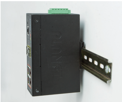
DINレールの取り付け
