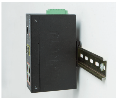
DINレールの取り付け
