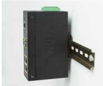
DINレールの取り付け
