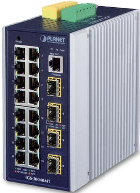
PLANETIGS-20040MTはフルマネージドギガビットファイバースイッチ 通常産業用ネットワーク向けに設計されています。それは特徴です 16 10/100 / 1000BASE-T 銅ポート、 4 1000BASE-X SFP ポートと冗長電源システムをIP30の頑丈でコンパクトなサイズのケースに収め、スペースの制限なしに困難な環境に設置できます。ユーザーフレンドリーでありながら高度な機能を提供します IPv6 / IPv4
