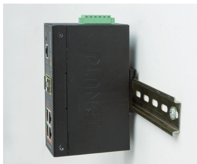
DINレールの取り付け
